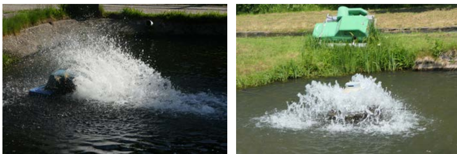
Abbildung 1: Verschiedene Belüfter zur Sicherstellung einer ausreichenden Sauerstoffversorgung in Haltungseinheiten für Regenbogenforellen, Fotos: © Thünen-Institut / Vincent Lugert.
