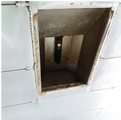
Abbildung 3: Geeignete Tränke in einem Transportfahrzeug für Rinder
