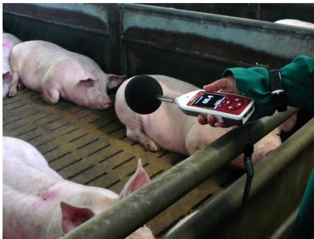
Abbildung 9: Geräuschpegelmessung im Wartebereich
